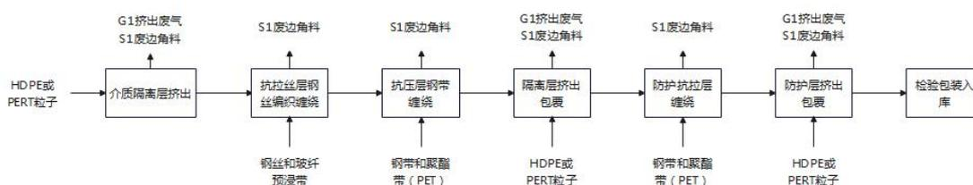
图 2-1 深海柔性管的工艺流程图
